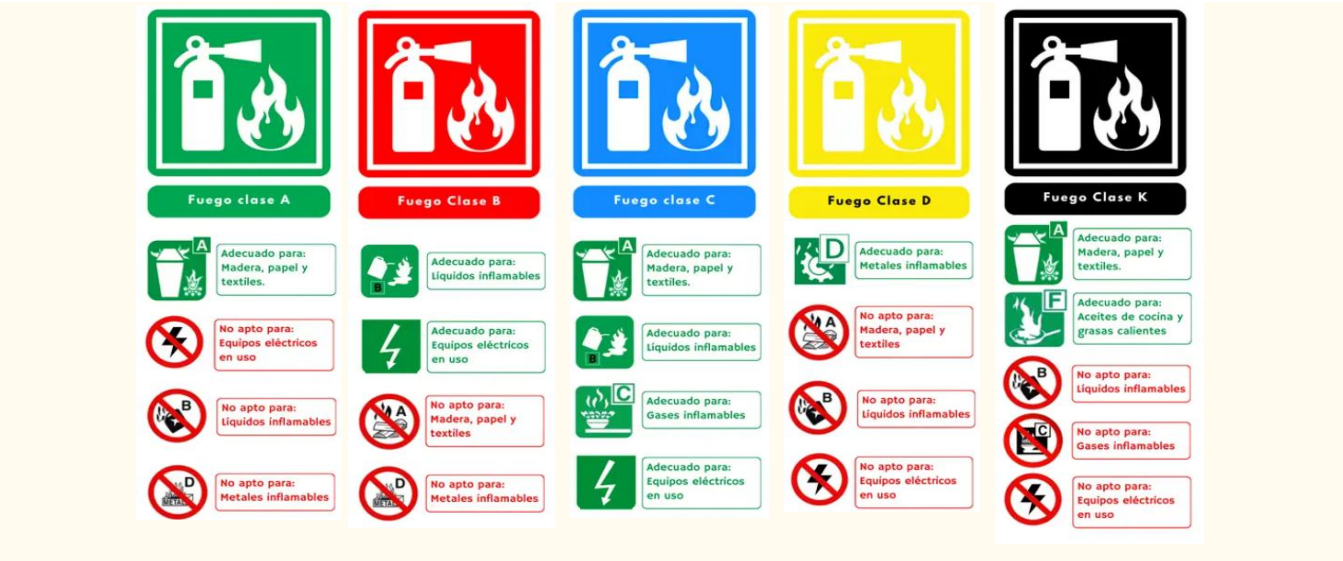
Ilustración 4: Tipo de extintores según su clase de fuego
